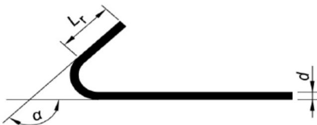
Dans le cas des ancrages, lorsque la justification de l'ancrage par le calcul impose  $L_r > 5 d$ , le diamètre intérieur de cintrage doit être justifié vis-à-vis de la rupture du béton.
